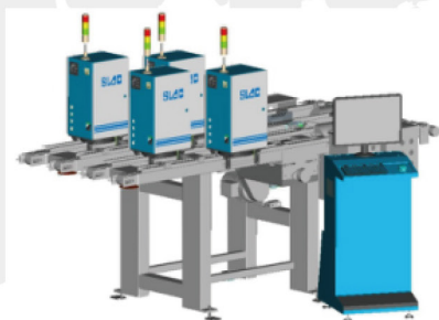
易拉盖图像检测系统
